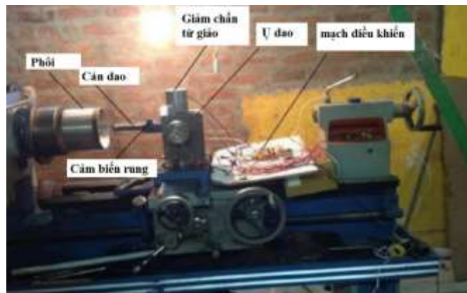
Hình 1.6: Ứng dụng kỹ thuật điều khiển lưu biến điện để giảm rung [74]
