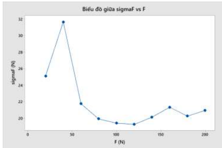
Hình 6.11: Quan hệ giữa lực từ và lực cắt TH3
