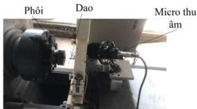
Hình 5.1: Mô hình thí nghiệm thu thập dữ liệu âm thanh khi tiện
