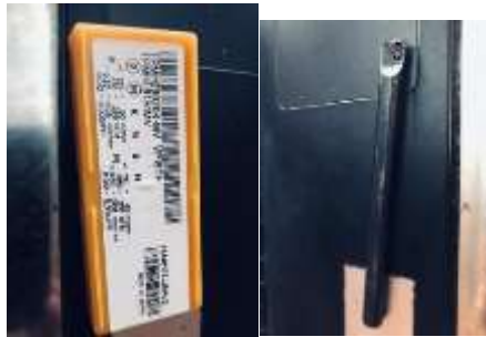
Hình 3.23: Thông số hạt dao và cán dao tiện
