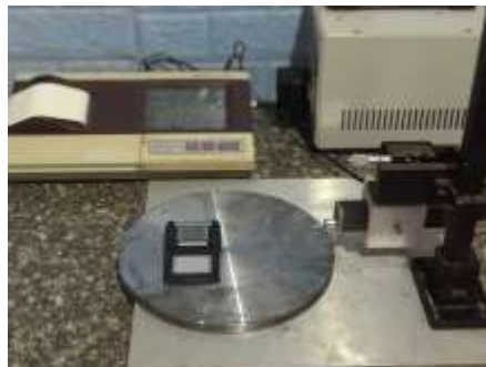
Hình 3.19: Máy đo độ nhám bề mặt chi tiết Mitutoyo SJ301
