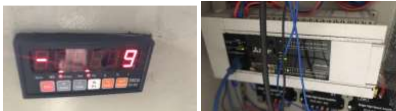
Hình 3.24: Bộ điều khiển cảm biến đo lực và bộ PLC điều khiển
