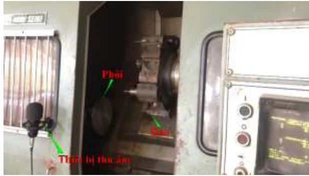
Hình 3.17: Thu thập âm thanh trong quá trình tiện mặt bích
