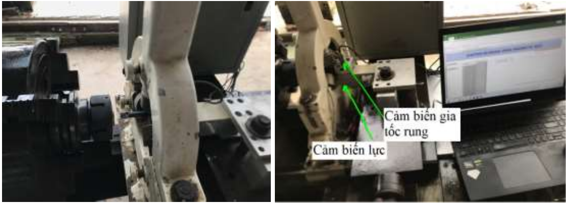
Hình 3.22: mô hình thí nghiệm lực từ cường bức
